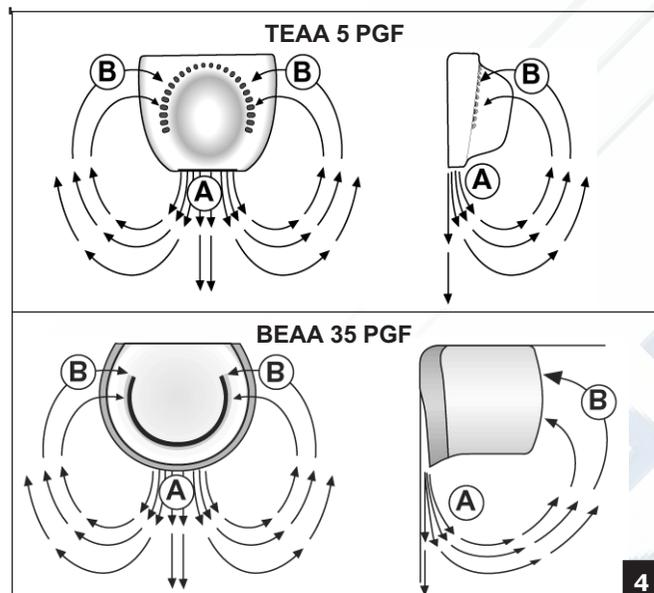
**A** – выдуваемый воздух, который охлаждается при соприкосновении с охлаждающей панелью;
