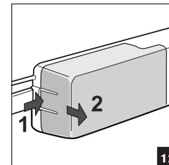
**BEAA 35 PGF:** Выверните перегоревшую лампу, как показано на рис. 13, и замените ее аналогичной, мощной которой не превышает 15 Вт.
